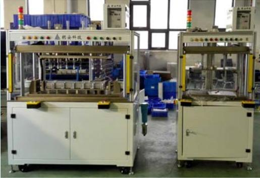
缸盖火花塞导管气密测试装置
