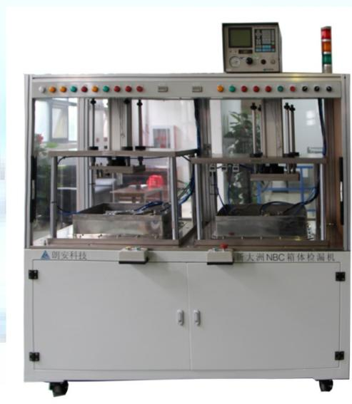
摩托车发动机左右箱体气密机
