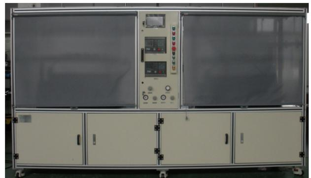
散热器气密测试中
