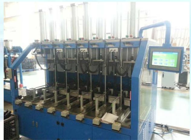
燃气塑钢转换管检漏装置
