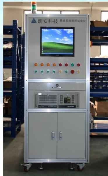
燃油系统气密及通气测试仪
