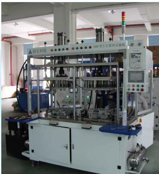
摩托车发动机测试专用设备用途：针对摩托车发动机左右箱体进行气密性检测及油孔贯通等项目的测试
