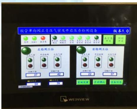
胶管检漏仪测试面板
